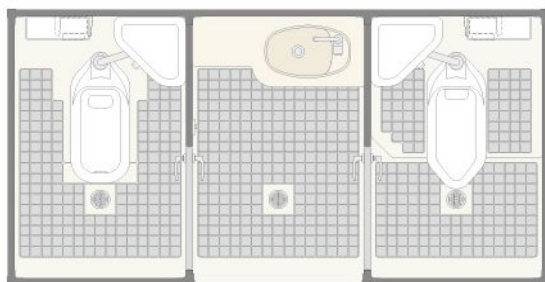
*3室タイプ 和+手洗+兼用和 *外寸(mm): W2528 × D1328 × H2528
