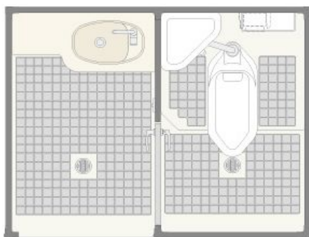
*2室タイプ 手洗+兼用和 *外寸(mm): W1707 × D1328 × H2528
